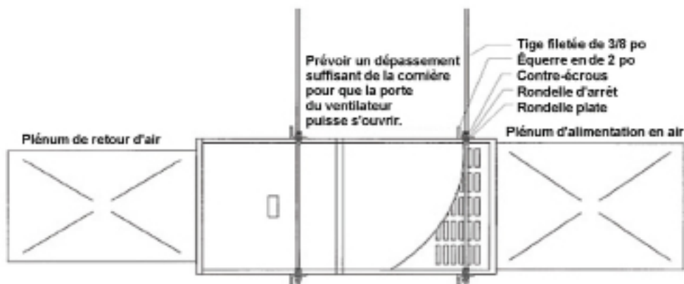
Figure 3 - Méthode suggérée pour suspendre un appareil de chauffage horizontal
