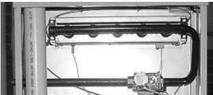
Figure 24 - Module du brûleur à flamme horizontale
