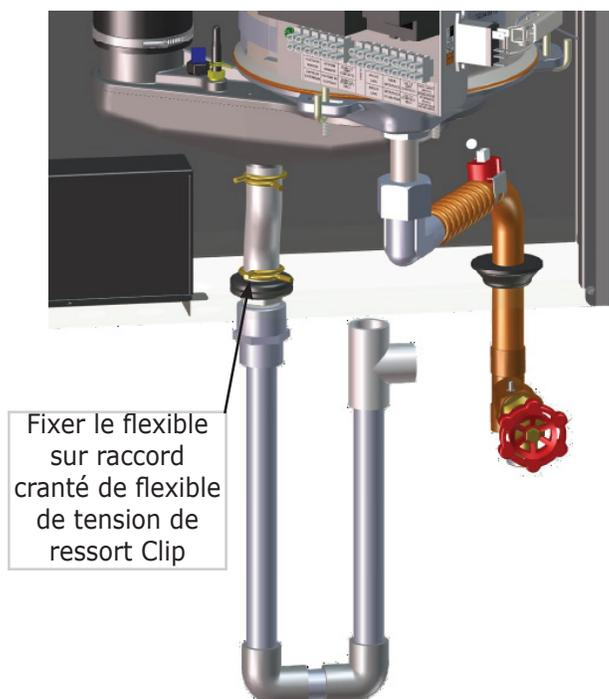
**FIGURE 5-2 Clapet de décharge de sécurité tuyauterie de décharge**
