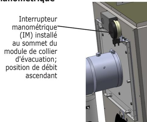
**Figure 7 : Orientation de l'adaptateur d'appareil, emplacement de l'interrupteur manométrique et raccordement adéquat des tuyaux pour assurer le bon fonctionnement de l'interrupteur automatique en cas d'obstruction de l'évacuation**
