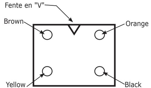
**Aquistat extrémité du faisceau de câblage**
