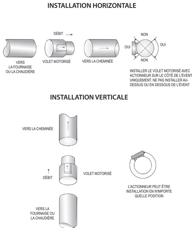
**Figure 9 - Emplacement du volet motorisé**
