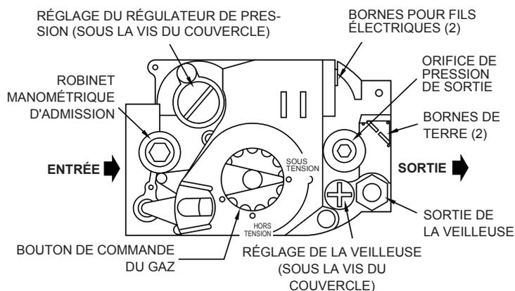
Vérifier ensuite s'il subsiste une odeur de gaz, y compris à proximité du plancher. S'il y a une odeur de gaz, ARRÊTER! Suivre les consignes de sécurité apparaissant en « B » plus haut. Si aucune odeur de gaz n'est détectée, passer à l'étape suivante.
