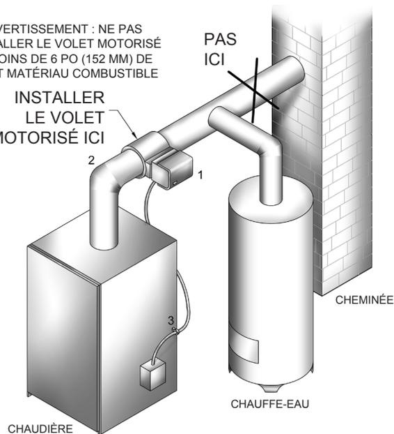
Vérifier annuellement le volet motorisé et toutes les surfaces de l'appareil exposées aux résidus de combustion en faisant particulièrement attention pour repérer tout signe de détérioration attribuable à la corrosion ou à d'autres sources. En cas de présence de corrosion ou de détérioration, contacter un chauffagiste agréé pour effectuer les réparations. Vérifier le fonctionnement du volet motorisé de la manière suivante :
